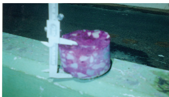
Figura 3 Medición de la carbonatación en la probeta
