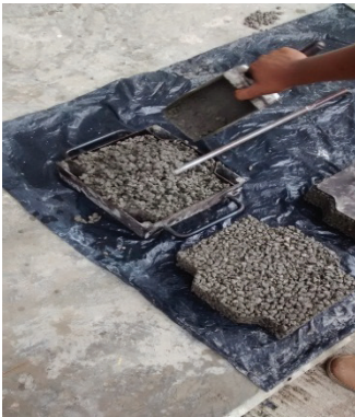
Figura 3. Elaboración de los adoquines con grava de 3/8
