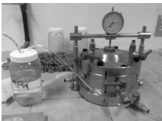
Figura 3 Técnica de transferencia de vapor mediante bomba de inducción
