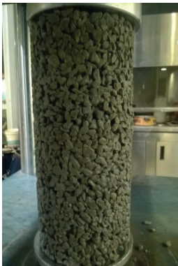
Figura 4. Ensayo a la compresión del cilindro de concreto permeable
