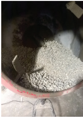
Figura 2. Elaboración del concreto permeable
