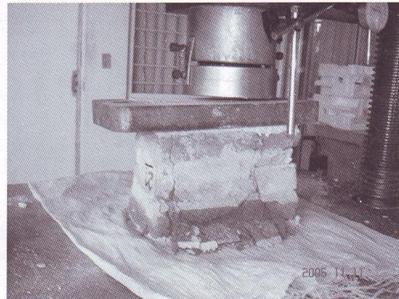
**Foto 5.** Ensayo a compresión de una pila de ladrillos.
