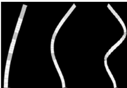
Figura 11. Formas modales de los tres primeros modos de vibración del espectacular, siendo dos traslacionales (en ejes x y) y un rotacional (en eje z). Modelo en SAP2000.
