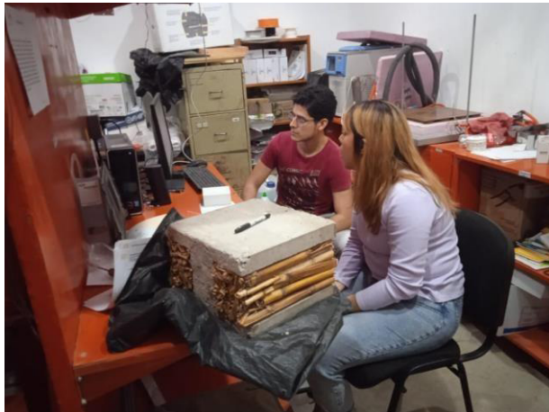
Figura 4. Sección de la losa térmica.
