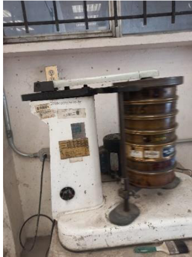
Figura 6. Tamizado de la muestra
