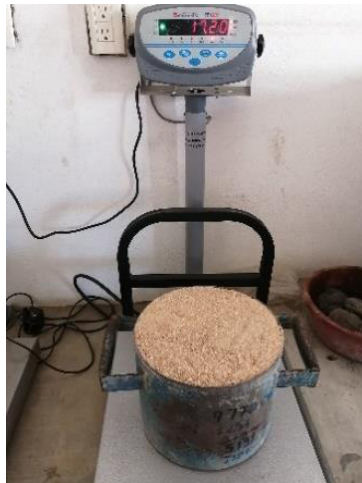
Figura 8. Cuarteo y pesaje de la muestra
