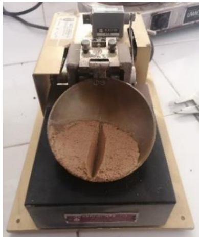
Figura 10. Prueba de casagrande
