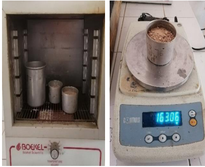
Figura 7. Pesaje y secado en muestra
