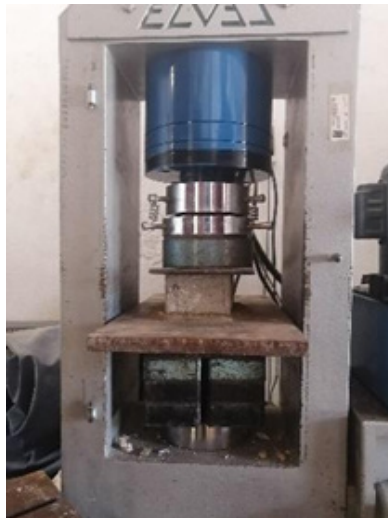
Figura 3. Prueba de compresión en adobe
