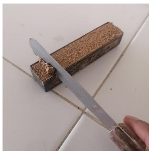
Figura 13. Vaciado y enrase de la muestra
